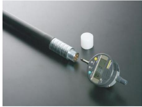
Medidor manual de los extensómetros de varillas
